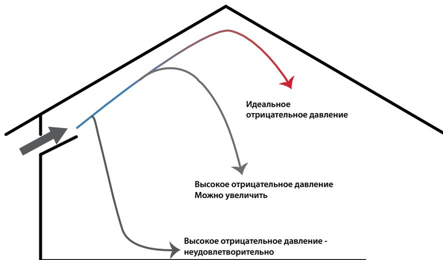
Высокая скорость воздуха также обеспечивает более эффективное смешивание входящего холодного воздуха с теплым воздухом птичника, который находится под коньком крыши (**Рис. 33**). Это не только нагревает входящий воздух, но также уменьшает его относительную влажность, позволяя ему абсорбировать влагу.
